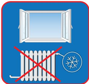
Beim Lüften Heizkörperventile schließen bzw. Raumthermostate zurückdrehen. Aber: Frostschutz beachten!
